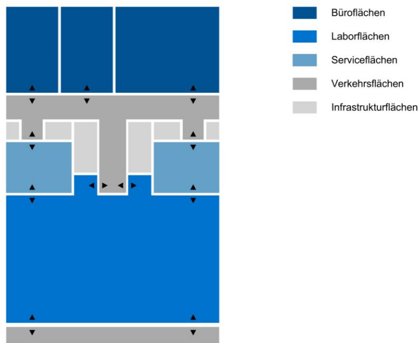
Abb. 2 Funktionsbereiche eines Laborgebäudes [10, S. 36] (Eigene Darstellung)
